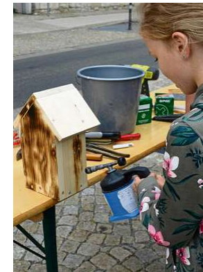
4 Sieht gut aus und macht Carlotta vor allem viel Spaß: Das Haus wird abgeflammt. Es kann dann mit Bienenwachs versiegelt werden.
