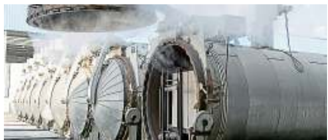
Dank einer geringen Temperatur und einer kurzen Zeitspanne in den Dampf-Härtekesseln wird bei der Produktion von Kalksandstein viel Energie eingespart. Fotos: epr/360° Design/Bundesverband Kalksandsteinindustrie e.V.
